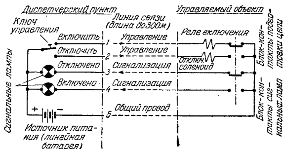
Рис. 124. Многопроводная схема дистанционного управления и сигнализации.
