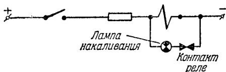
Рис. 15. Схема замедления притяжения якоря реле с лампой накаливания.
